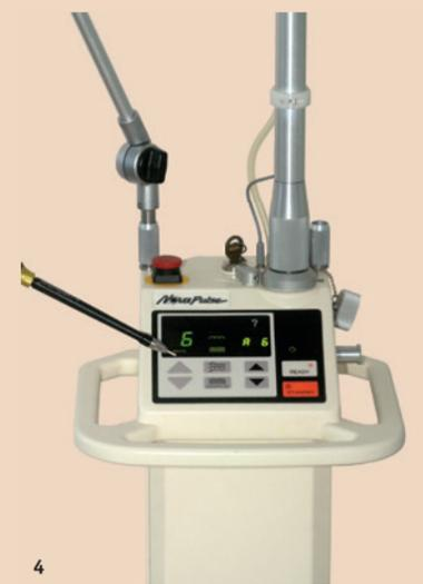
Abb. 4: CO<sub>2</sub>-Laser mit Handstück mit Keramikspitze (links).
