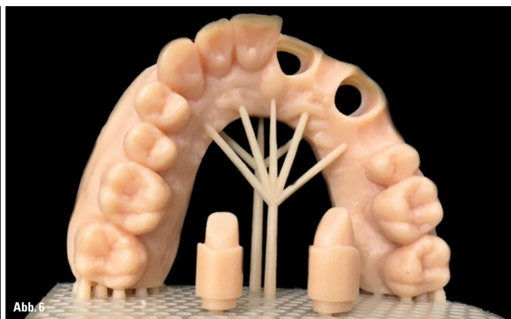
Abb. 5: Bis zur fertigen, passgenauen Schiene sind es nur wenige Arbeitsschritte. – Abb. 6: Im Drucker hergestelltes Alveolen-Modell nach dem Druckprozess.
