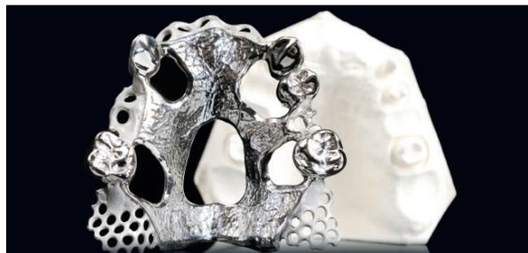
„Hot stuff“ ist Sherahavy-metal, die neue Dentallegierung für Kombiarbeiten und Klammerprothesen. Sie schmilzt homogen auf und hat den optimalen Schmelzspiegel bei 1.500 Grad Celsius erreicht. Ihre Vorteile spielt die moderne Legierung im erkalteten Zustand aus: Die Kobalt-Chrom-Legierung bietet ein Plus an Festigkeit bei gleichzeitig erhöhter Elastizität.
