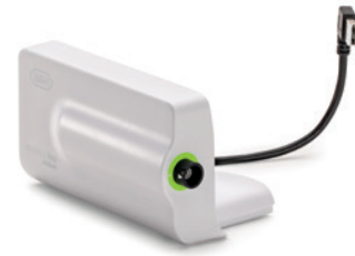
Abb. 3: Das neue W&H Osstell ISQ-Modul bringt durch Messung und Dokumentation der Implantatstabilität zusätzliche Sicherheit und langfristige Erfolge.
