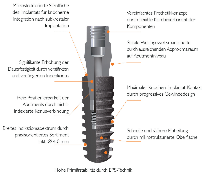
Abb. 1: Konstruktionselemente und ihre Bedeutung.
