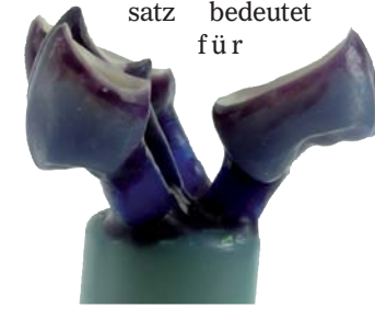
Die überpressten Teile einer Brücke aus Lava™ Zirkon sind fertig zum Einbetten – und kurze Zeit später auch bereit für den Versand. Das Corona Lava™ Fräszentrum Starnberg setzt mit seiner Corona-Technik-Offensive 2010 voll auf die digitale Fertigung.
