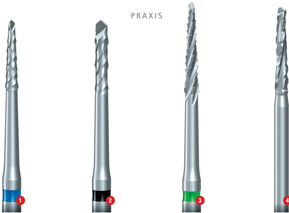
Abb. 1: Der kreuzverzahnte H254E, 6 mm lang, 1,2 mm konisch: grazil, schnittfreudig, auch für extrem dünne Schnitte geeignet. Abb. 2: Der kreuzverzahnte H255E, zylindrisch: wie der konische H254E, aber mit höherer Schnitffreudigkeit insbesondere an der Instrumentenspitze. Abb. 3: Der H162SL, 8 mm lang, 1,4 mm konisch: besonders schnittfreudig durch spezielle Sägeverzahnung. Abb. 4: Der H162ST, 9 mm lang, 1,6 mm konisch: schnittschärfster Knochenfräser in der typischen Lindemann-Dimension. Innovative Komet ST-Verzahnung, erstmals vorgestellt im März 2015.
