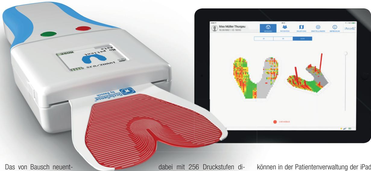
Das von Bausch neuentwickelte System vereint die traditionelle und digitale Darstellung der Druckverhältnisse auf den Okklusalfächern. Das Handgerät wird in Kombination mit einem nur 60 µm dünnen Einmaldrucksensor mit roter Farbbeschichtung verwendet. Dieser Sensor wird genau wie eine herkömmliche Okklusionsprüffolie angewendet. Die Kaukraft des Patienten wird
