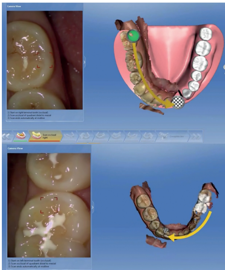
Abb. 1: Guided Scanning: Die Software führt den Benutzer durch den Scanpfad und erstellt gleich das zugehörige Modell.
