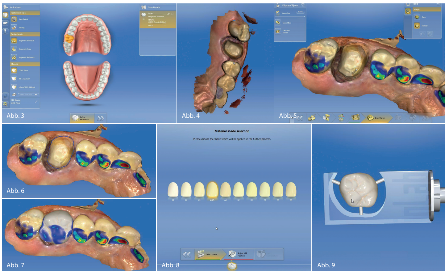
Abb. 3: Indikationsauswahl mit der CEREC Software 4.5. Abb. 4: Der Scan mit der CEREC Omnicam. Abb. 5: Deutliche Darstellung von Zahnschubstanz und Gingiva. Abb. 6: Eingezeichnete Präparationsrand. Abb. 7: Der Kronenvorschlag der Software. Abb. 8: Farbauswahl in der CEREC Software. Abb. 9: Schleifvorschau.
