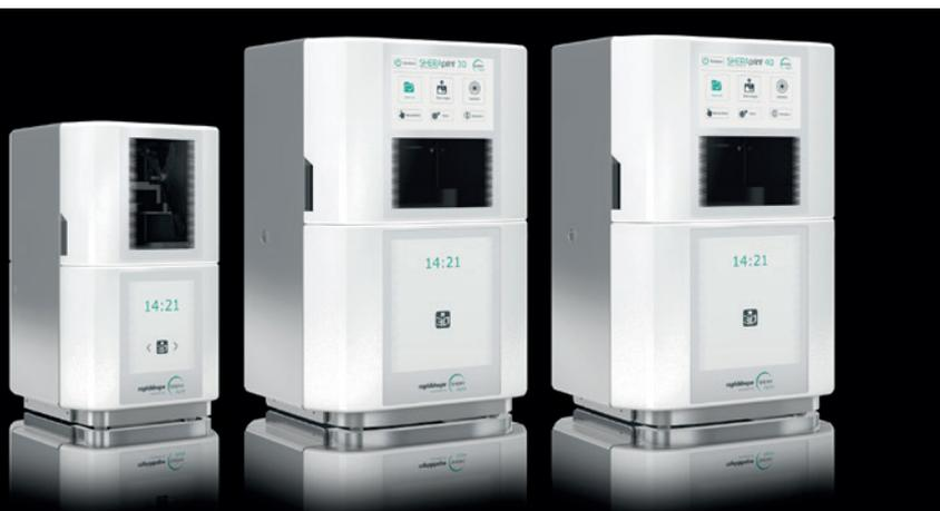
Die Sheraprinter arbeiten mit HD-Auflösung von 1.920 x 1.080 Pixel entsprechend 34 Mikrometern. Bei Sheraprint 90 beträgt die Auflösung WQXGA mit 2.560 x 1.600 Pixel entsprechend 38 Mikrometern für hohe Präzision auf größerer Fläche. Die Druckleistung bei allen Sheraprint-Druckern beträgt mit der Force Feedback Technologie abhängig von Material und Schichtstärke bis zu 110 Millimeter pro Stunde.
