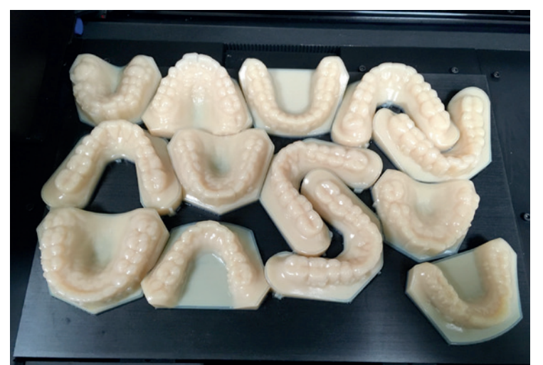
Abb. 6: Ungereinigte Modelle nach dem Druck.
