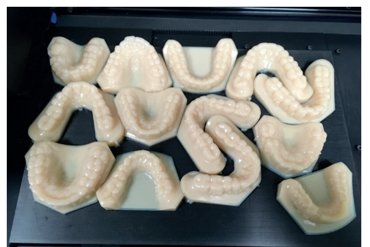
Abb. 6: Ungereinigte Modelle nach dem Druck.
