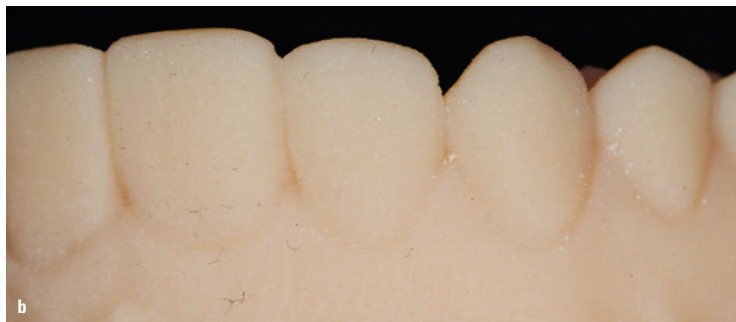
Abb. 4a, b: Modell aus dem Filament-Drucker (a) und aus dem PolyJet-Drucker (b) im Detail.
