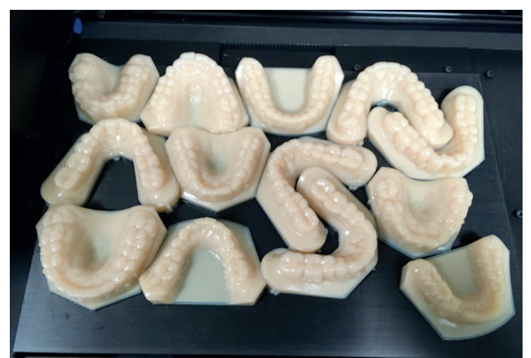
Abb. 6: Ungereinigte Modelle nach dem Druck.
