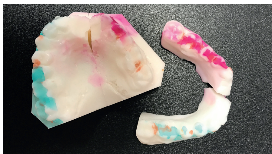
Abb. 9: Modellbruch bei Streuen auf nicht isoliertem Modell.
