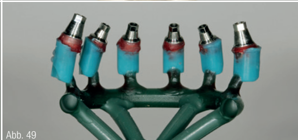
Abb. 46: Angestiftet mit Kennzeichnung. Abb. 47: Ein perfekter Guss ohne Fehlstellen. Abb. 48: Im OK in Wachs gefräst. Abb. 49: Angestiftet im offenen Ring. Abb. 50: Beeindruckend die Oberflächengüte und satte Farbe.
