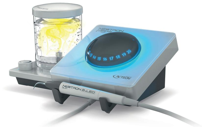
des vorgesehenen Einsatzes. Über den Drehknopf am Gerät kann die gewünschte Leistungsstufe eingestellt werden, welche visuell in der passenden Farbe angezeigt wird. Somit ist eine zu hohe oder zu niedrige Leistungseinstellung ausgeschlossen. Dank der linearen Ultraschallschwingung ist eine schmerzfreie und gewebeschonende Behandlung möglich.
