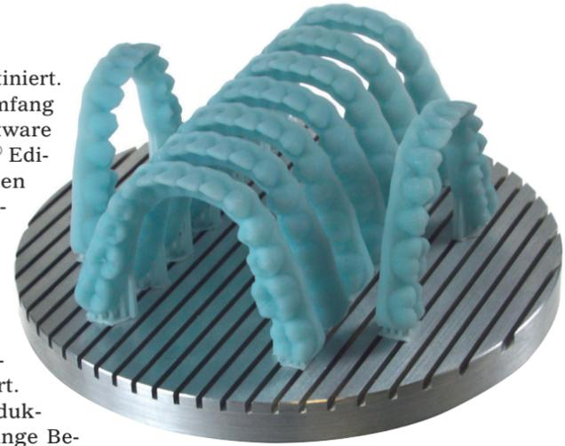
Im KFO-Bereich ist der 3D-Printer u. a. für den Druck von Modellen für das Tiefziehen von Alignern geeignet.
