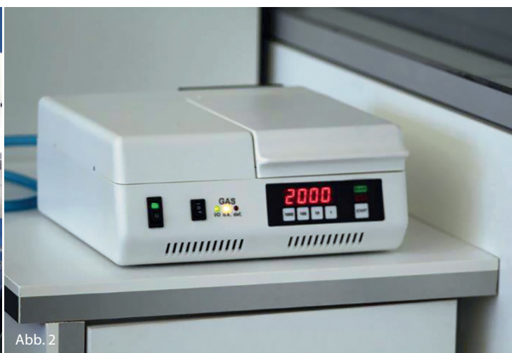
Abb. 1: Einfüllen des Harzes in die Materialwanne. Abb. 2: Otofash G171 – Nachbelichtung mit 2.000 Blitzen.
