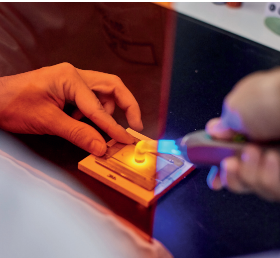
Abb. 4: Herstellung eines lichtgehärteten Prüfkörpers aus RelyX Unicem 2 Selbstadhäsiver Composite-Befestigungszement zur Beurteilung der mechanischen Festigkeit.
