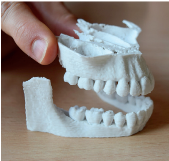
Abb. 1: FDM-gedrucktes Chirurgieplanungsmodell mit sehr deutlicher Rillenbildung nach der Produktion. (Quelle: https://vexamtech.com/Indien/ )
