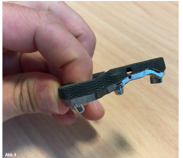
Abb. 3: Stumpfm Modelle aus einem ProJet/MJP-Drucker ohne Nachhärtung. Direkt nach Wachsupport-Entfernung. (Quelle: https://www.3dsystems.com/dental ) – Abb. 4: Kombination aus 3D-Metalldruck und Frästechnik. Steckbare Stegarbeit mit Nacharbeit in einer Dentalfräsmaschine, um die gewünschte Passung und Oberflächengüte sicherzustellen. (Quelle: 3dsystems)
