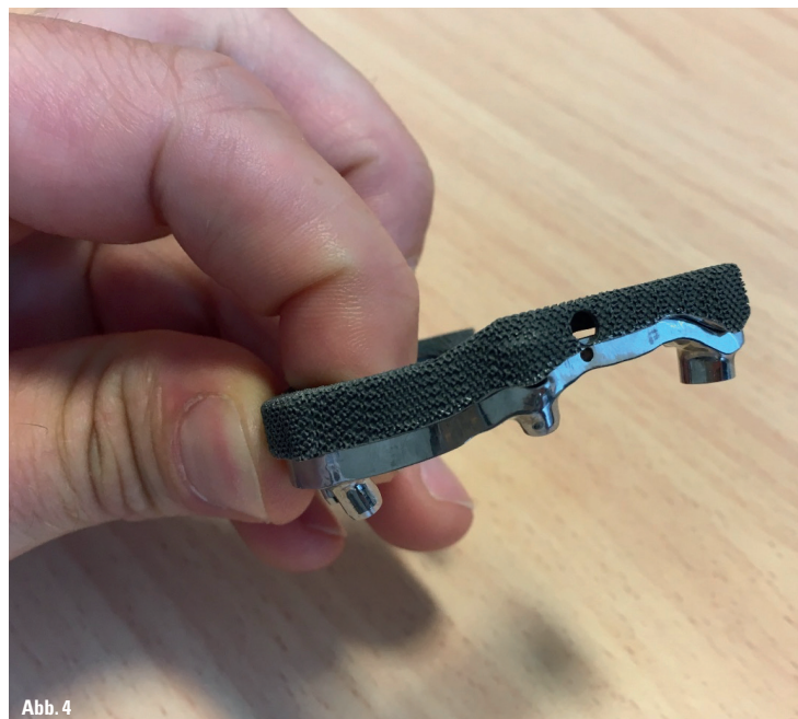
Abb. 3: Stumpmodelle aus einem ProJet/MJP-Drucker ohne Nachhärtung. Direkt nach Wachsupport-Entfernung. (Quelle: https://www.3dsystems.com/dental ) – Abb. 4: Kombination aus 3D-Metalldruck und Frästechnik. Steckbare Stegarbeit mit Nacharbeit in einer Dentalfräsmaschine, um die gewünschte Passung und Oberflächengüte sicherzustellen. (Quelle: 3dsystems)
