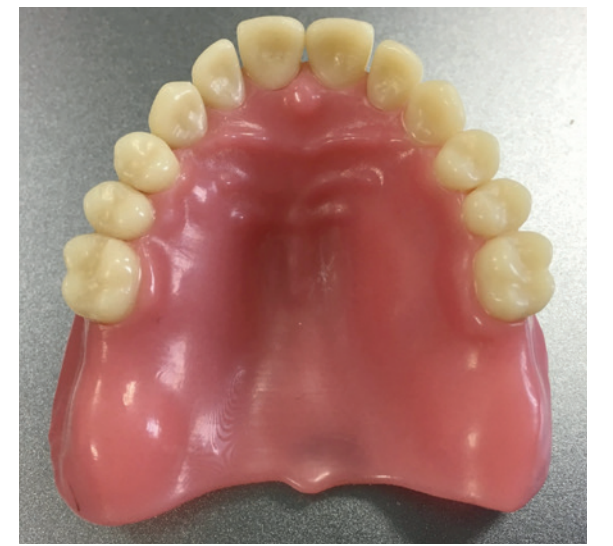
Abb. 2: Gedruckte Prothesenbasis ohne Nachbearbeitung aus einem DLP-Drucker mit Figur 4-Technologie. Die Standardzähne wurden mit klarem Druckmaterial eingebracht und gehärtet.
