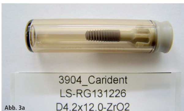
Abb. 3: Die verwendeten Keramikimplantate: a) Steriler Probekörper. b) Unsteriler Probekörper.
