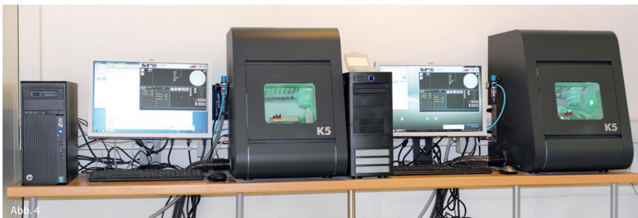
Abb. 4: Zuletzt wurden zwei vhf K5 Fräsmaschinen angeschafft, die ältere Maschinen ersetzen und für Kunststoffe und Zirkon eingesetzt werden.
