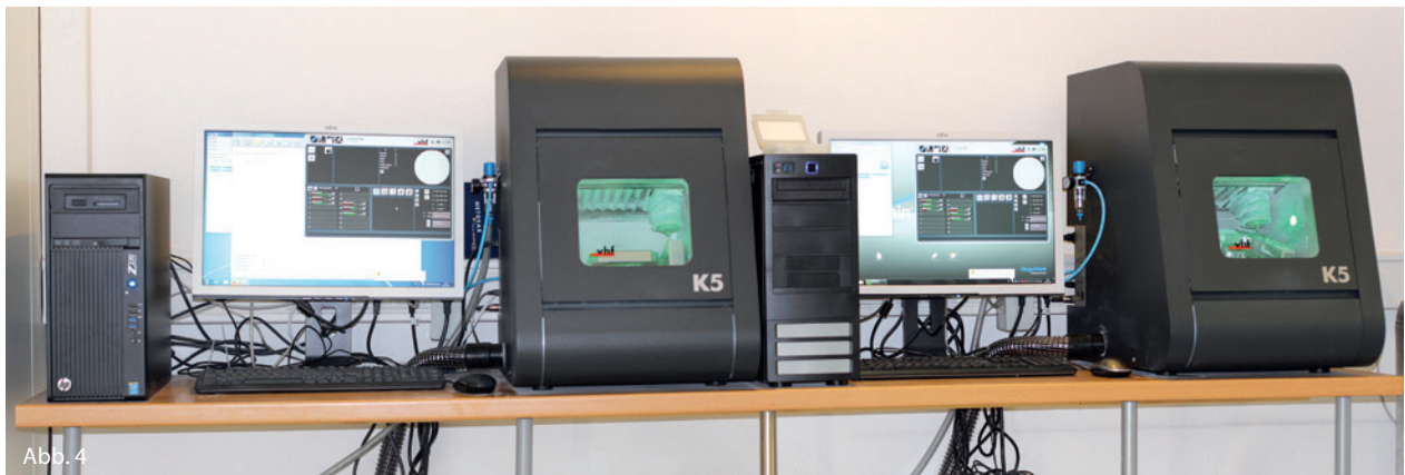
Abb. 4: Zuletzt wurden zwei vhf K5 Fräsmaschinen angeschafft, die ältere Maschinen ersetzen und für Kunststoffe und Zirkon eingesetzt werden.
