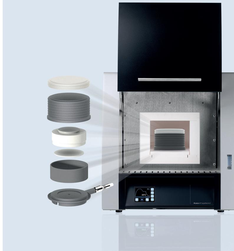
gleichzeitig für einen optimalen Schutz der gefrästen Einheiten. Unabhängig ihrer Größe können diese zukünftig in nur einem Durchgang gesintert werden. Auch der Sinterprozess von weitspannigen Arbeiten konnte im Zuge des Ceramill Argovent 2 verbessert werden. Auf der deutlich vergrößerten „Float Sintering Disc“ lassen sich auch sehr breite Restaurierungen bequem und sicher platzieren, bevor sie ihre end-
