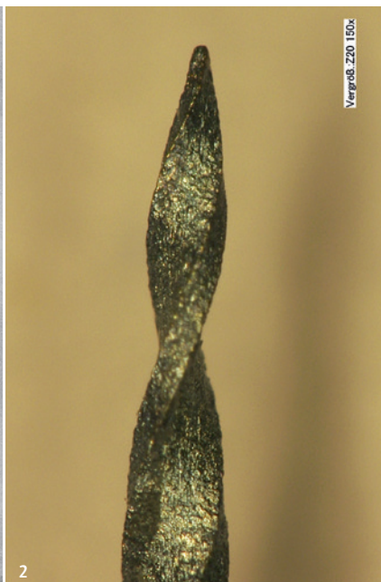
Abb. 1: Präoperative Röntgenaufnahme von Fall 1. – Abb. 2: Spezialgehärtete Oberfläche der HyFlex EDM-Feile unter dem Mikroskop.
