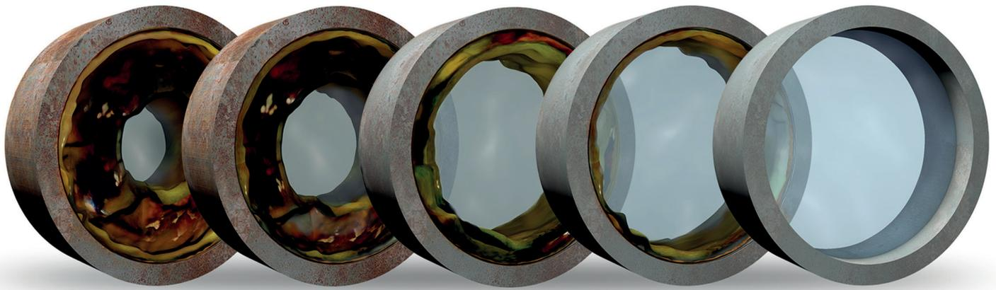
**Biofilm in Rohranlagen:** Ablagerungen können in jedem Rohr entstehen. Die in den Biofilmen sich ansiedelnden Keime können so in den Wasserkreislauf gelangen und gefährden die Gesundheit der Verbraucher.
