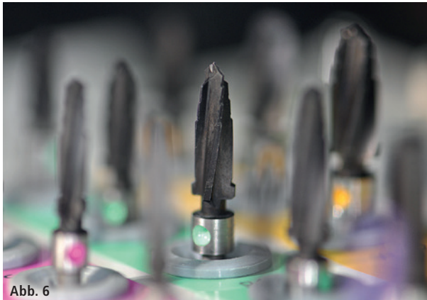
Abb. 6: XT-Profilbohrer farbcodiert mit Karbonbeschichtung. – Abb. 7: Pilot- und Profilbohrer: enossale Länge 10 mm zzgl. 0,6 mm im Halsbereich.
