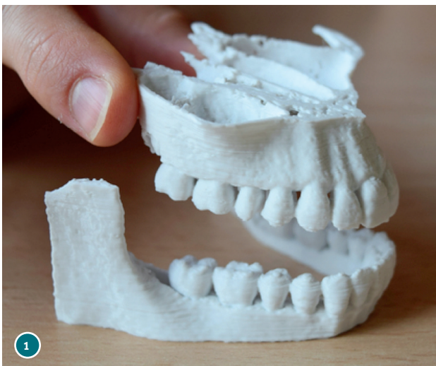
Abb. 1: FDM-gedrucktes Chirurgieplanungsmodell mit sehr deutlicher Rillenbildung nach der Produktion. (Quelle: https://vexmatech.com [Indien]) – Abb. 2: Gedruckte Prothesenbasis ohne Nachbearbeitung aus einem DLP-Drucker mit Figur 4-Technologie. Die Standardzähne wurden mit klarem Druckmaterial eingebracht und gehärtet.
