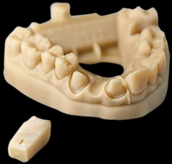
Abb. 3: Stumpfmodelle aus einem Projekt/ MJP-Drucker ohne Nachhärtung. Direkt nach Wachssupport-Entfernung. (Quelle: https://www.3dsystems.com/dental )
