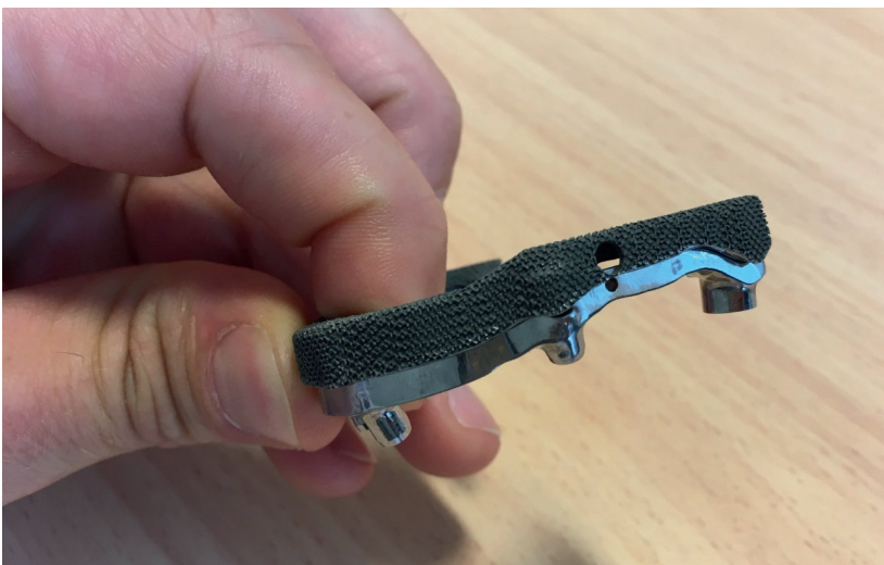
Abb. 4: Kombination aus 3D-Metalldruck und Frästechnik. Steckbare Stegarbeit mit Nacharbeit in einer Dentalfräsmaschine, um die gewünschte Passung und Oberflächengüte sicherzustellen. (Quelle: 3dsystems)
