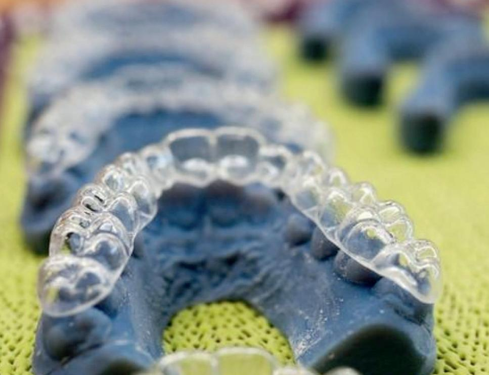
**Abb. 12:** Gedruckte Modelle nach der Aligner-Produktion, kurz vor der Endreinigung und dem Versand zum Kunden. (Quelle: Denny Gille, <https://www.handwerk.com>)
