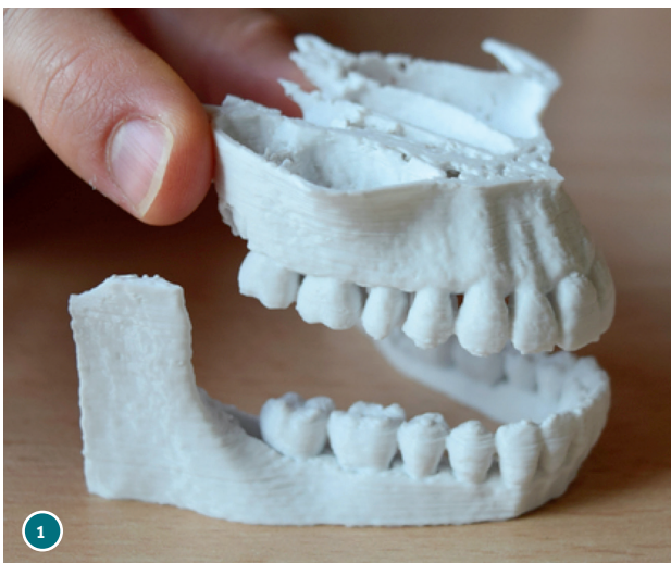
Abb. 1: FDM-gedrucktes Chirurgieplanungsmodell mit sehr deutlicher Rillenbildung nach der Produktion. (Quelle: https://vexmatech.com [Indien]) – Abb. 2: Gedruckte Prothesenbasis ohne Nachbearbeitung aus einem DLP-Drucker mit Figur 4-Technologie. Die Standardzähne wurden mit klarem Druckmaterial eingebracht und gehärtet.
