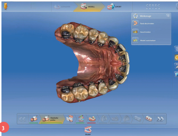
Abb. 3: Beim Intraoralscan (CEREC Omnicam®, Fa. Dentsply Sirona) wird auch im Bereich der Brackets eine hohe Qualität mit fast artefaktfreier Darstellung erzielt, die mit konventionellen (Alginat-)Abdrücken so nicht zu erreichen wäre. – Abb. 4: Die mit einem Intraoralscanner erfassten virtuellen Modelle können direkt mit dem Patienten besprochen werden und sind bei der Veranschaulichung von Behandlungsindikationen ausgesprochen hilfreich.
