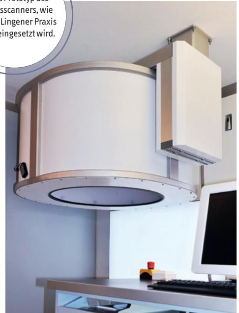
vor einiger Zeit einen Prototypen (Abb. 3) entwickelt, mit dem sich schnell und einfach ein Gesichtsscan durchführen und erste Erfahrungen sammeln lassen.
