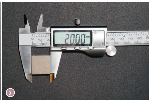
Abb. 1: Alignerherstellung auf gedrucktem Modell. – Abb. 2: Modell aus einem Filament-Drucker (links) sowie ein im PolyJet-Verfahren hergestelltes Modell (rechts). – Abb. 3: Hohe Präzision bei einem mittels PolyJet-Drucker gedrucktem Messwürfel.
