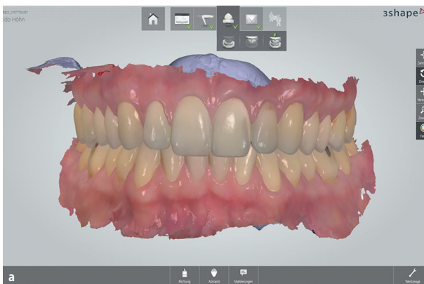
Abb. 9a, b: TRIOS®-Farbscan (a). Farbinformationen gehen beim Speichern als STL-Datei leider verloren (b).
