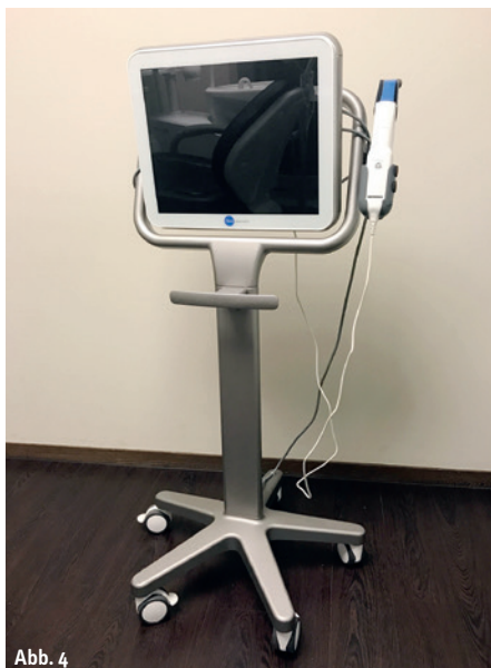
Abb. 4, 5: Intraoralscanner iTero® Element™ (Align Technology Inc.) mit bereits zweitem Ersatzkabel (Abb. 4). TRIOS® 3 Scanner (3Shape) mit Pistolengriff (Abb. 5).
