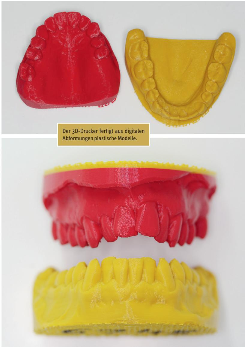
Der 3D-Drucker fertigt aus digitalen Abformungen plastische Modelle.
