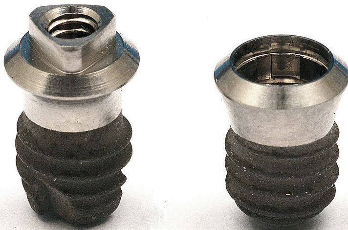
Abb. 1: Dreieckförmiger Orthosystem ® -Implantatkopf (Straumann AG, Basel/Schweiz) zur Verbindung mit der Suprastruktur (links). Tissue Level Implantat, Standard Plus, Ø 4,1 mm, Länge 4 mm, Plattform RN – Regular Neck, Schulter-Ø 4,8 mm (Straumann AG, Basel/Schweiz) (rechts).
