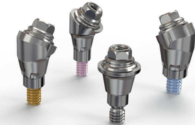
Abb. 2a: Das angulierte Abutment bietet durch seine zweiteilige Konstruktion die volle Wandstärke und die volle Gewindeunterstützung für die Brückenschraube. – Abb. 2b: Die Aufbauten passen für das Astra Tech Implant System® sowie OsseoSpeed® Profile EV-Implantate und sind in den Ausführungen gerade, 17 Grad und 30 Grad sowie in verschiedenen Gingivahöhen verfügbar.
