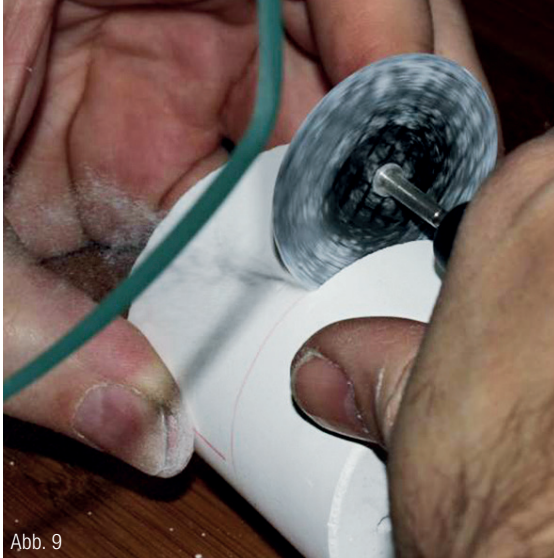
Abb. 6: Positionierung der Werkstücke im Muffelring. Abb. 7: Einbetten mit GC LiSi™ PressVest. Abb. 8: Einsetzen des Pressstempels. Abb. 9 und 10: Ausbrennen: Mit einer diamantierten Trennscheibe wird in die Einbettmasse eingeschnitten.
