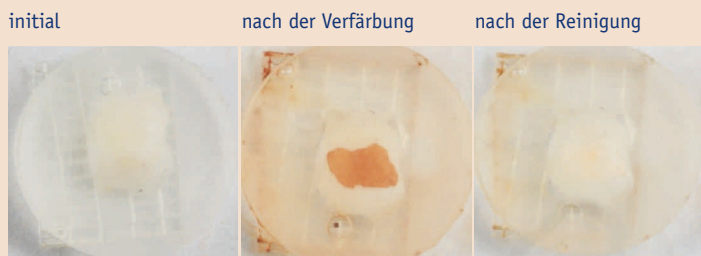
Fotografische Abbildung der Zahnschmelzproben im Ausgangszustand, nach Verfärbung und nach der Reinigung. Die Reinigung der Proben erfolgte mit einer cellulosehaltigen Zahnpasta. (© Foto Fraunhofer IMWS)
