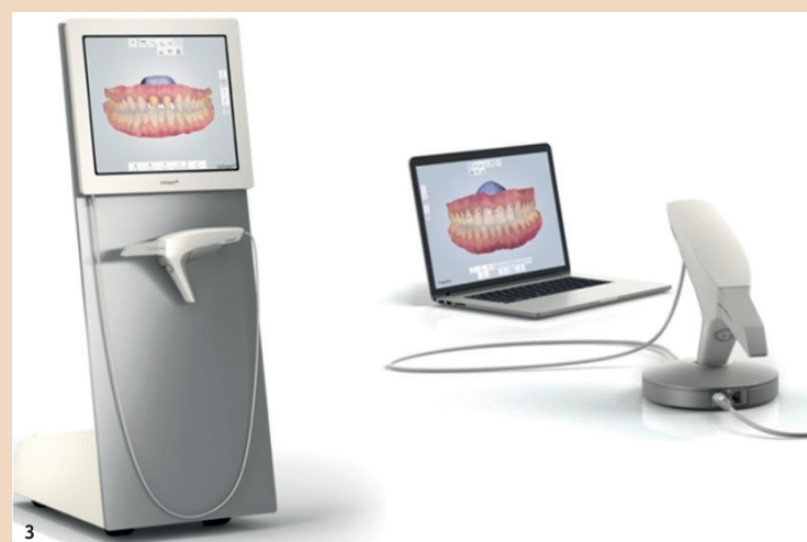
Abb. 3: Zwei Geräte-Varianten werden unterschieden: die Cart- (links) und die Laptop-Version (rechts). Im Bild: TRIOS® Intraoralscanner von 3Shape.
