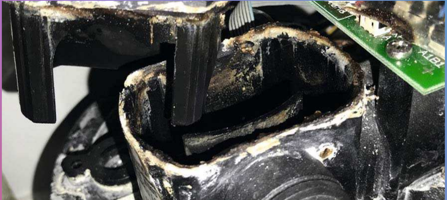
Pilze in der freien Fallstrecke einer Dentaleinheit
