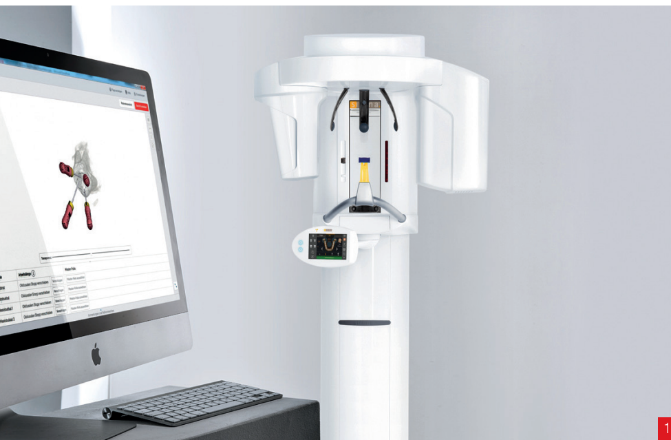
Abb. 1: Mithilfe von 3D-Röntgendaten (hier: Orthophos SL, Dentsply Sirona Imaging) lassen sich in der neuen 3D Endo Software Wurzelkanalbehandlungen planen, im Voraus virtuell durchspielen und dabei optimieren. Abb. 2: Die 3D-Darstellung aller Wurzelkanäle des betroffenen Zahns und ihrer genauen Verläufe ermöglicht eine exakte Visualisierung und daher Einschätzung des Behandlungserfolgs und erleichtert die Behandlungsplanung.
