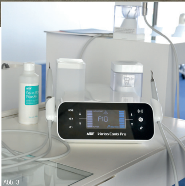
Abb. 2: Der Eingangsbereich der im Jahr 2016 eingeweihten Erweiterung des Firmengebäudes in Eschborn bereitet Gästen ein herzliches Willkommen. Abb. 3: Die 2-in-1-Prophylaxe-kombination Varios Combi Pro bietet Ultraschallscaler und Pulverstrahlgerät in einem und sorgt so für eine effiziente und komfortable Zahnreinigung und Biofilmentfernung. Abb. 4: Das europäische Zentrallager garantiert durch seinen umfassenden Bestand eine schnelle Lieferfähigkeit sämtlicher in Europa verkaufter NSK-Produkte.
