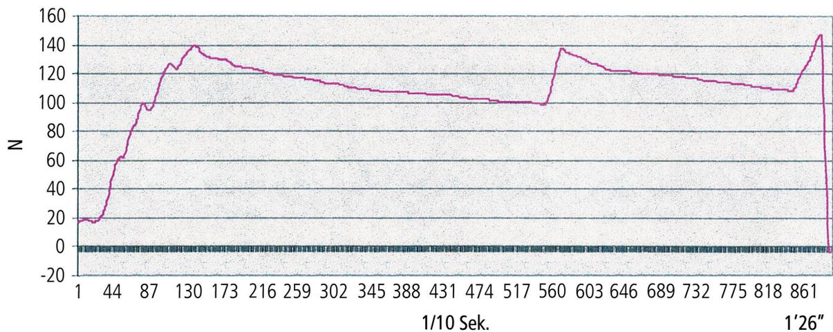
**Abb. 2:** Aufzeichnung der Seilspannkraft während einer Benex®-Extraktion: Nach Aufbau der Zugkraft (Zackenlinie) kommt es innerhalb von Minuten zu einer spontanen, sukzessiven Reduktion der Seilspannung, d. h. die Parodontalfasern reißen und die Wurzelretention lässt nach.
