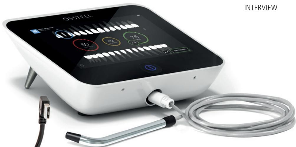
geschraubt, wobei dieser fixiert werden muss. Dann wird das Handstück perpendikulär von bukkal und dann von mesial an den Pfosten geführt, um den ISQ-Wert zu messen. Die Messung wird in der Regel drei Mal wiederholt, um zu prüfen, ob die Messwerte mehr oder weniger identisch sind.
