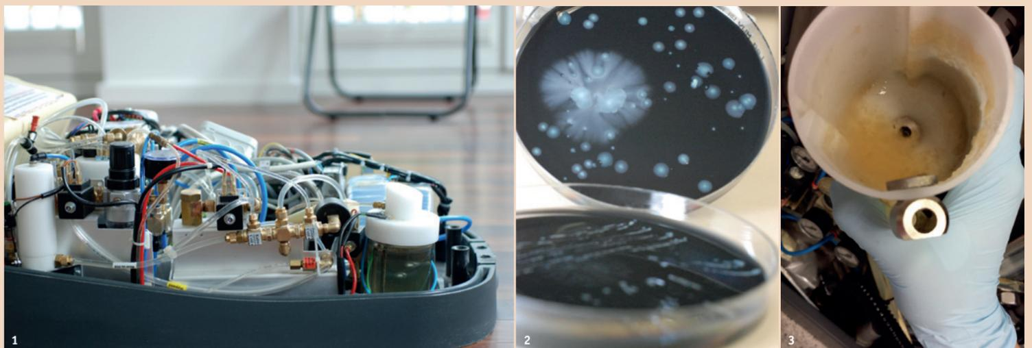
Abb. 1: Komplexes Schlauchsystem einer Dentaleinheit. – Abb. 2: Legionellenkulturen aus der Wasserprobe einer Dentaleinheit. – Abb. 3: Biofilm in der freien Fallstrecke einer Dentaleinheit.
