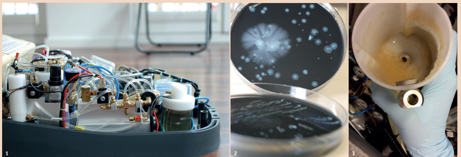
Abb. 1: Komplexes Schlauchsystem einer Dentaleinheit. – Abb. 2: Legionellenkulturen aus der Wasserprobe einer Dentaleinheit. – Abb. 3: Biofilm in der freien Fallstrecke einer Dentaleinheit.
