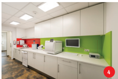
Abb. 3: Empfang und Wartezimmer werden mit einem Multifunktionsmöbel getrennt. – Abb. 4: Im Steri-Raum unterstützen die verschieden farbigen Rückwände die Trennung reiner und unreiner Bereiche.
