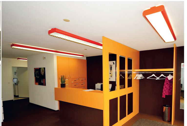
Links: Empfangsfront mit Strukturplatte MDF weiss lackiert und Abdeckung in Corian® Design Glacier White 12 mm mit eingefrästem Logo. Rechts: Empfang vor dem Umbau.
