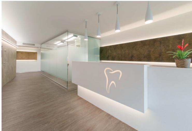
Links: Empfangsfront mit Strukturplatte MDF weiss lackiert und Abdeckung in Corian® Design Glacier White 12 mm mit eingefrästem Logo.
