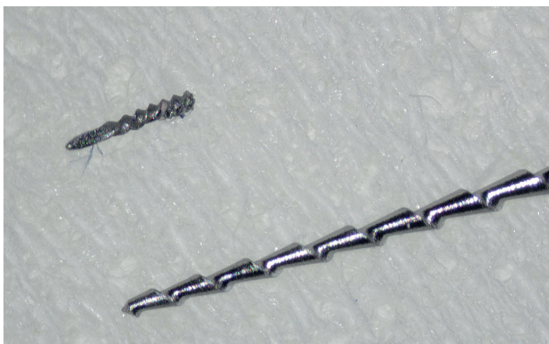
Abb. 6: Separierte Ultraschallspitze im Vergleich mit einer Hedström-Feile ISO 10.
