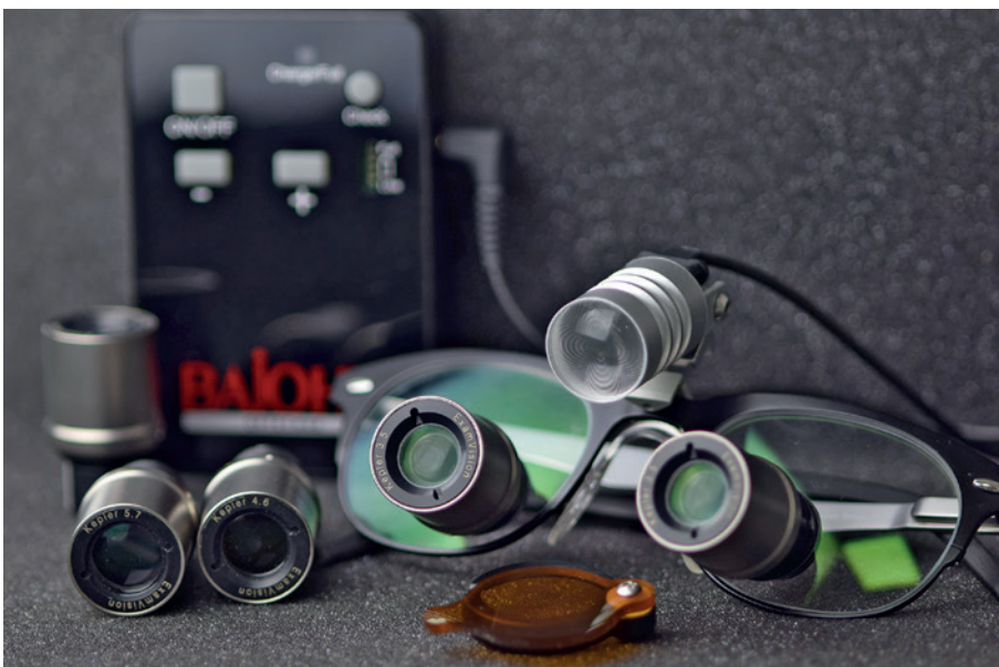
Abb. 1: Für endodontisch ambitionierte Generalisten – innovative Keplersche Lupenbrille mit umrüstbaren Vergrößerungsoptiken und koaxialer LED-Beleuchtung.
