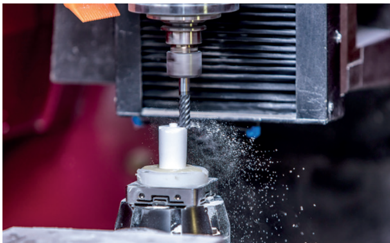
Abb. 8: Computergestütztes Fräsen eines CERASORB®-Formteils.
