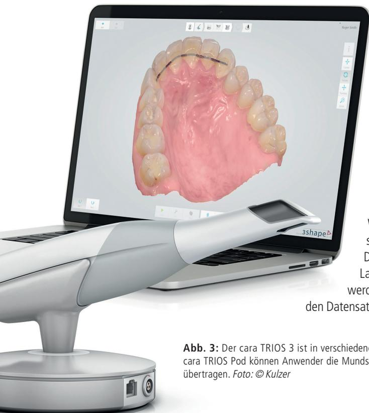
**Abb. 3:** Der cara TRIOS 3 ist in verschiedenen Varianten erhältlich. Mit dem cara TRIOS Pod können Anwender die Mundsituation direkt auf ihren Laptop übertragen. Foto: © Kulzer
