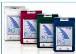
modell mit, zumal er ebenfalls nach der bewährten Quotientenmethode arbeitet. Dabei werden die Impedanzen zweier Stromfrequenzen (400 Hz und 8 kHz) gemessen, was eine absolut exakte Längen-
